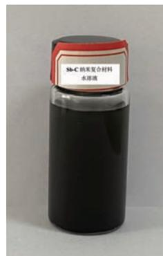
图 1 Sb-C 纳米复合材料水溶液
