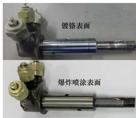
图 4 钛合金零件镀铬与爆炸喷涂表面对比
