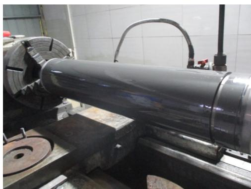
图 3 油缸活塞杆涂层封孔处理
