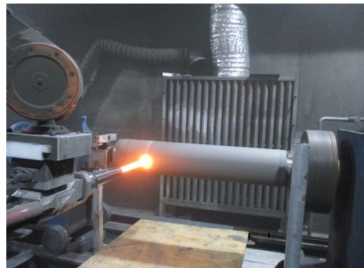
图 2 油缸活塞杆热喷涂
