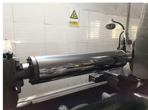
图 4 油缸活塞杆涂层抛光处理
