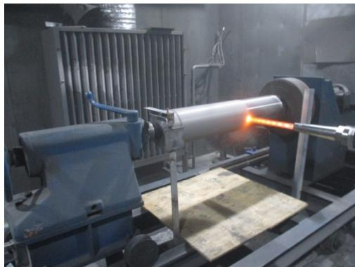
图 1 油缸活塞杆热喷砂
