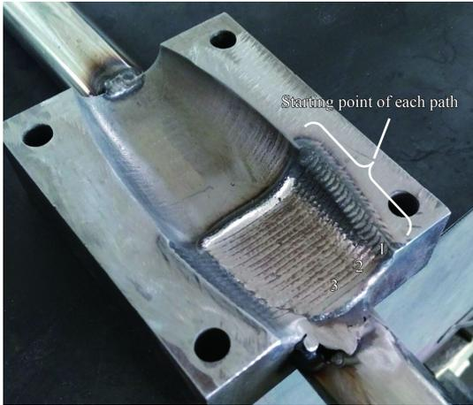
图8 镍基合金在曲面上的熔覆层形貌
