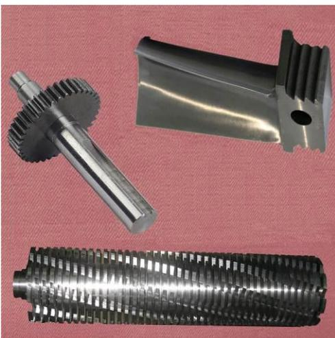
图 3 硬质膜层强化的叶片、齿轮和刀具
