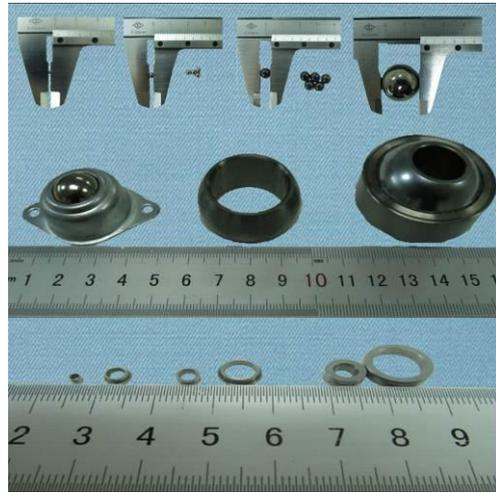
图 2  $Me^+ + N^+$ 离子注入的微型轴承和关节轴承
