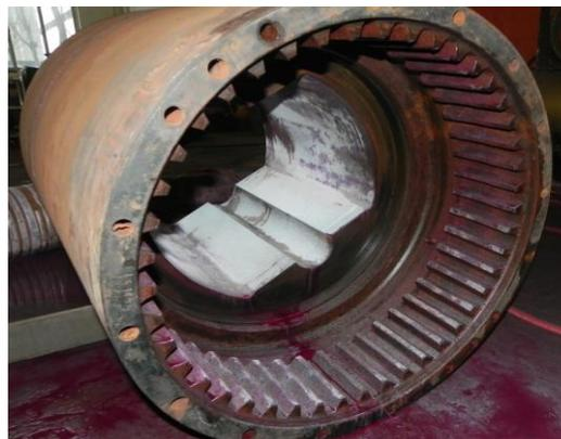
图 4 扁头套修复后的表面探伤
