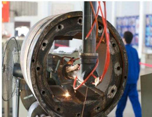
图 2 扁头套激光熔覆中
