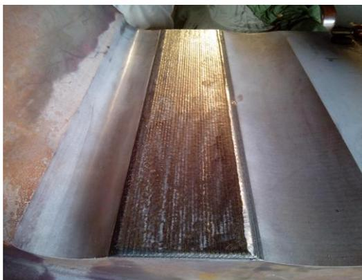
图 3 扁头套激光熔覆后状态
