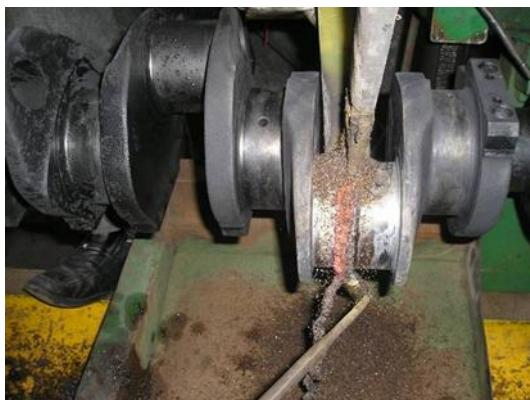
图 3 窄间隙埋弧焊修复曲轴损伤部位
