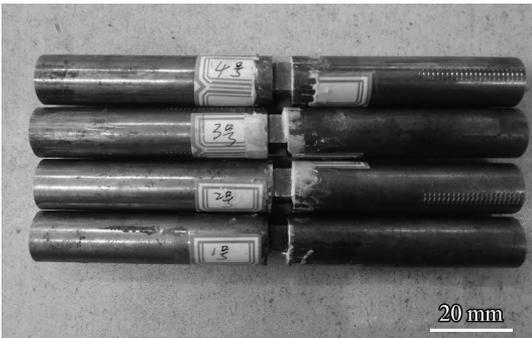
图8 对偶件试样的宏观形貌
