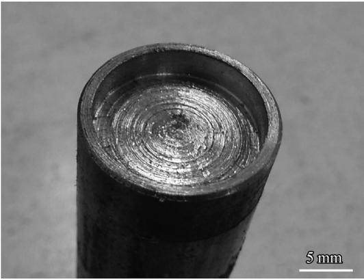
图7 定位盲孔的宏观形貌
