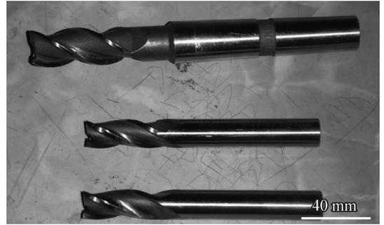
图 1 激光熔覆高熵合金涂层铣刀
