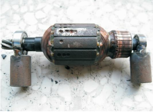
图 4 电机转子轴承钢与 45 钢焊接(TWE312R-16 型焊条,Φ 4 mm, I<sub>t</sub>=140 A)
