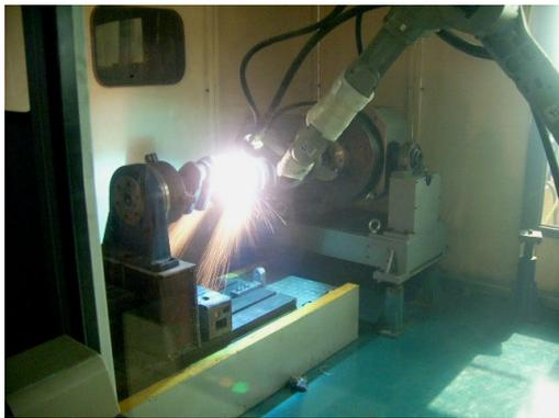
图6 机器人自动化喷涂发动机曲轴过程照片
