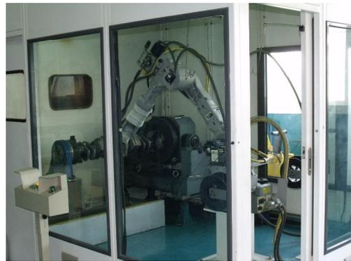
图2 机器人自动化高速电弧喷涂系统主体部分
