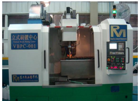
图6 发动机缸体自动化纳米电刷镀再制造专机
