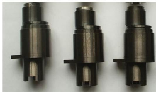
图2 PI IID 处理后的偏心轴照片
