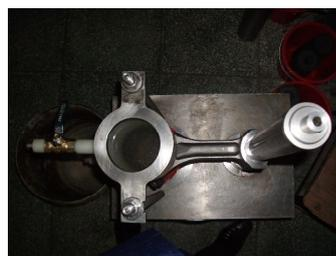
图4 连杆模拟刷镀试验装置
