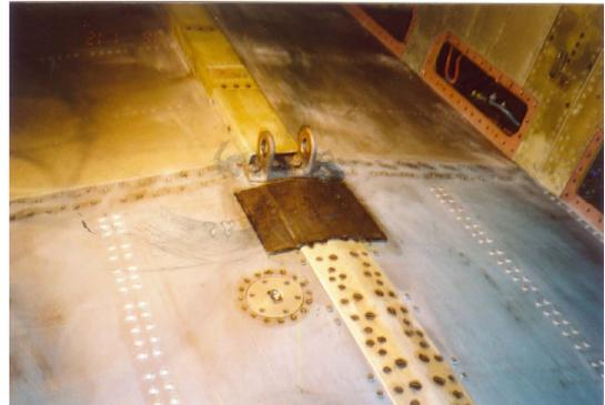
图 3 机身裂纹已经修复
