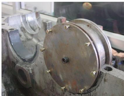
图3 轴承外套定位模具
