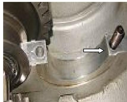
图 1 磨损失效的变速箱轴承外套
