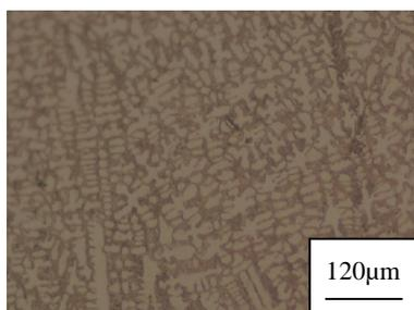
图3 1号试样熔覆层组织
