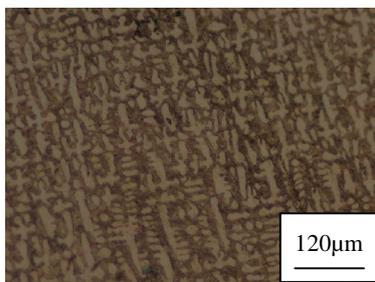
图10 8号试样熔覆层组织
