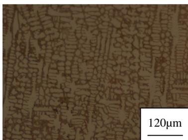
图7 5号试样熔覆层组织
