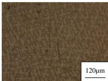
图8 6号试样熔覆层组织
