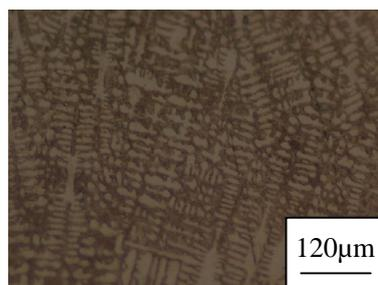
图5 3号试样熔覆层组织
