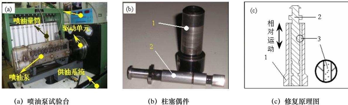
图2 喷油泵试验台及修复系统原理图 (1-柱塞套; 2-柱塞; 3-纳米铜)
