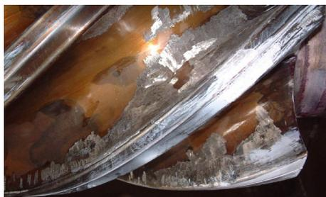
图 13 转子工作面损伤状态
