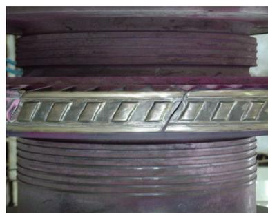
图 12 激光再制造后的围带铆钉
