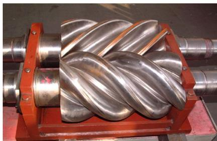
图 14 激光再制造后的转子副
