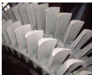
图 7 再制造后叶片及组装后转子
