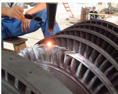
图 11 围带铆钉激光熔覆中
