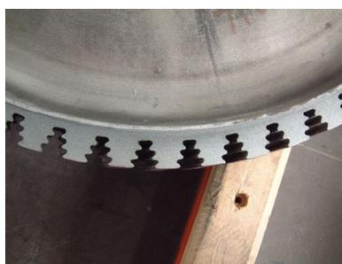
图 8 激光再制造后的烟机轮盘
