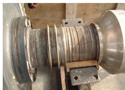
图 9 激光再制造后的主轴径
