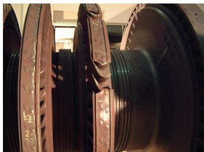
图 10 围带铆钉损伤状态
