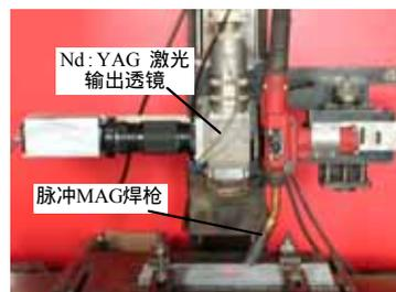
图1 激光+GMAW电弧复合热源焊接机头
