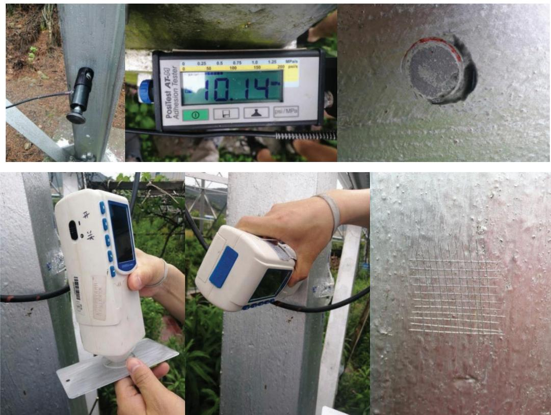
图7 国网宁波北坞2321线06级铁塔漆膜现场测试照片(检测时间:2021年3月)
