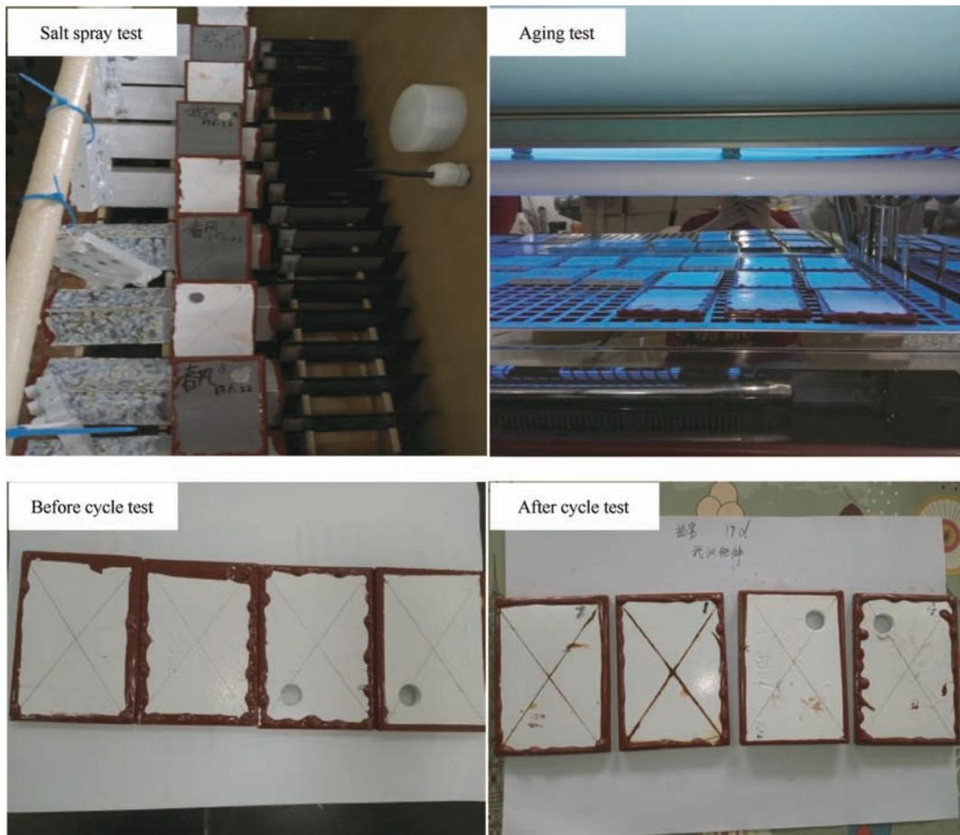
图4 石墨烯改性重防腐涂料的耐盐雾循环老化的测试照片
