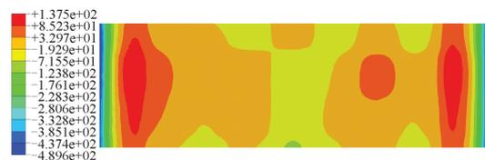
图 4 基于轮廓法测量试样表面残余应力分布云图
