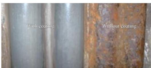
图7 垃圾炉管排受热面运行半年后有高频感应重熔涂层与无涂层对比<sup>[36]</sup>
