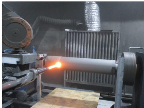
图 2 油缸活塞杆热喷涂
