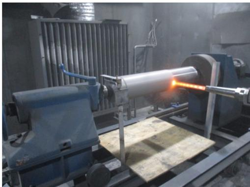
图 1 油缸活塞杆热喷砂
