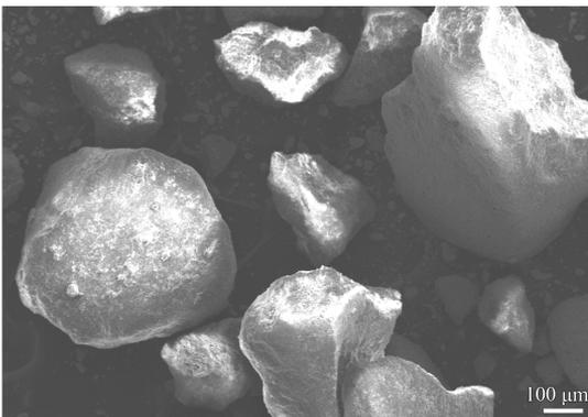
图 2 550  $\mu\text{m}$  (30 目) 沙粒的微观形貌
