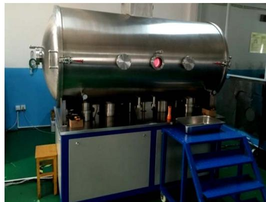
图 4 轴承离子注入工业化批量生产设备
