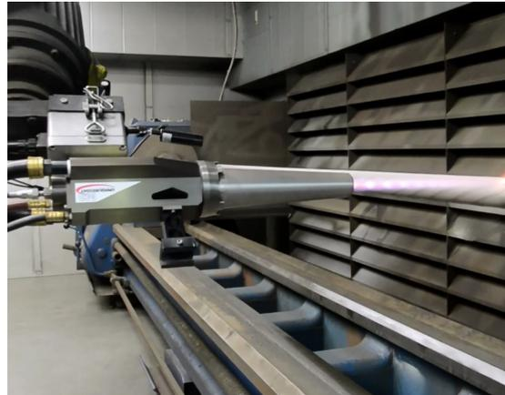
图 2 HVOF-M3 喷涂强化石油高速螺杆转子
