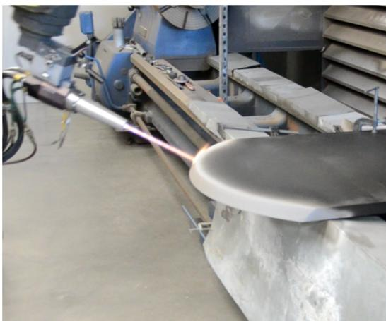
图 3 HVOF-M3 喷涂强化阀门闸板
