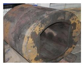
图 1 粗轧机扁头套修复前
