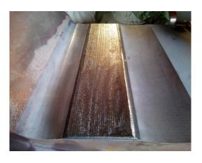
图 3 扁头套激光熔覆后状态
