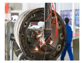
图 2 扁头套激光熔覆中
