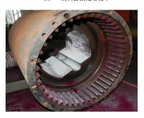
图 4 扁头套修复后的表面探伤
