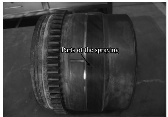
图6 正时齿轮密封部位修复图
