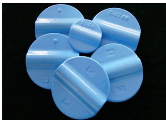
图 4 用于海水淡化工程的尼龙 11 涂装蝶阀阀片
