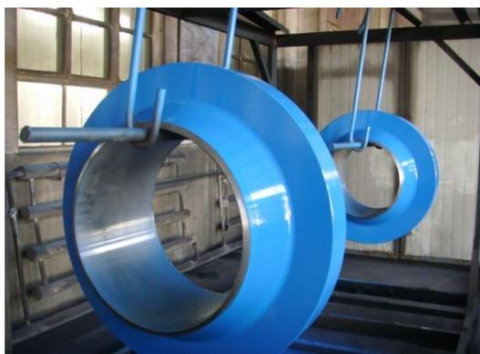
图 1 悬挂在生产线上的尼龙 11 涂装法兰
