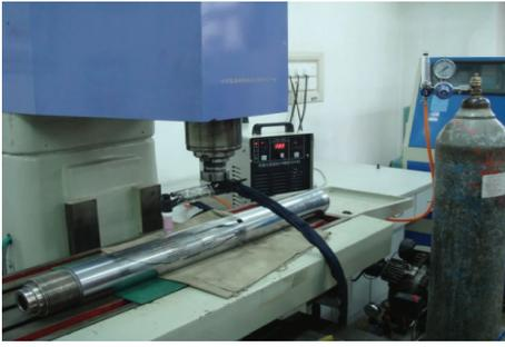
图9 液压柱塞杆的自动修复现场
