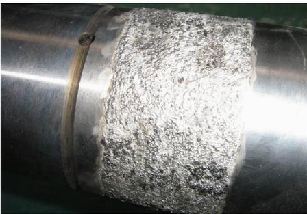
图11 修复后的零件表面
