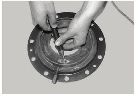
图13 弹子槽特形面的修复
