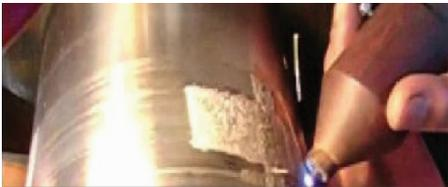
图10 电火花修复轴类零件表面磨损现场
