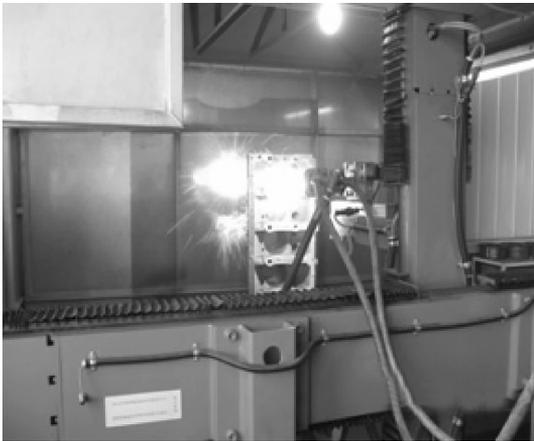
图 11 发动机缸体自动化高速电弧喷涂再制造过程
