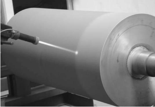
图8 造纸辊 HVOF 修复再制造过程
