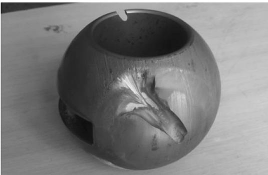
图9 磨损失效的球阀
