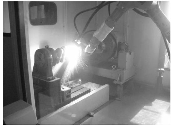
图 12 发动机曲轴机器人自动化高速电弧喷涂再制造过程
