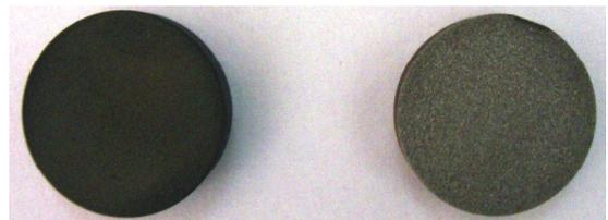
图3 涂层热震前后的表面状态
