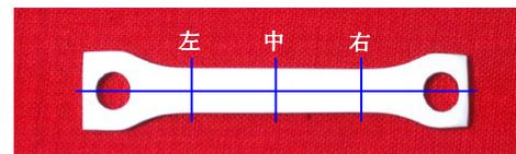
图 2 磁畴试样及检测点布置
