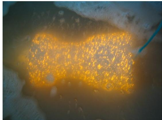
图 2 汽车轮毂表面等离子火花放电过程
