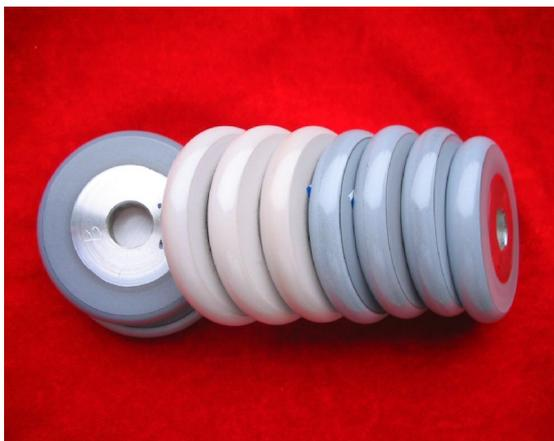
图 3 等离子体电解氧化处理的铝合金摩擦盘
